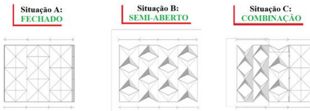
Figura 36: Estrutura de Origami para Fachada. (Fonte: FACHADA VARIABLE, 2018)
