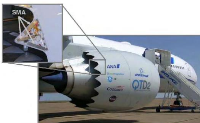
Figura 19: Representação da SMA utilizada na parte de trás da turbina da aeronave (Fonte: HARTL, 2010)
