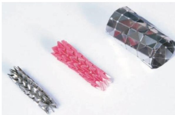
Figura 8: Protótipo de um Stent baseado em técnicas de origami (a) forma contraída, (b) forma expandida (Fonte: FEI e DUREISSEIX, 2012).
