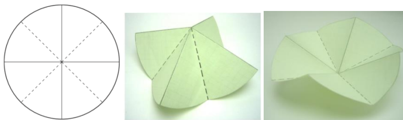
Figura 3: Padrão de oito vincos do Waterbomb (Fonte: HANNA et al., (2014)).
