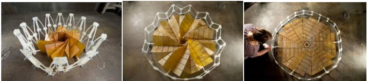
Figura 6: Protótipo desenvolvido pela NASA de uma matriz de Painel Solar sendo desdobrada (Fonte: LANDAU, 2014).
